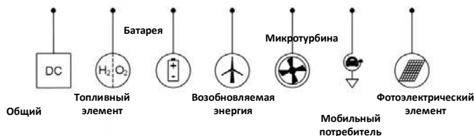
Рис. 1-10. Обозначения элементов, работающих на постоянном токе
