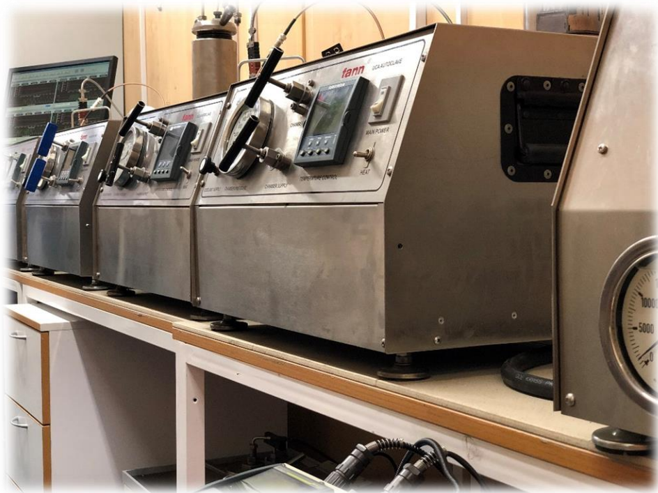
Ультразвуковой анализатор цемента
